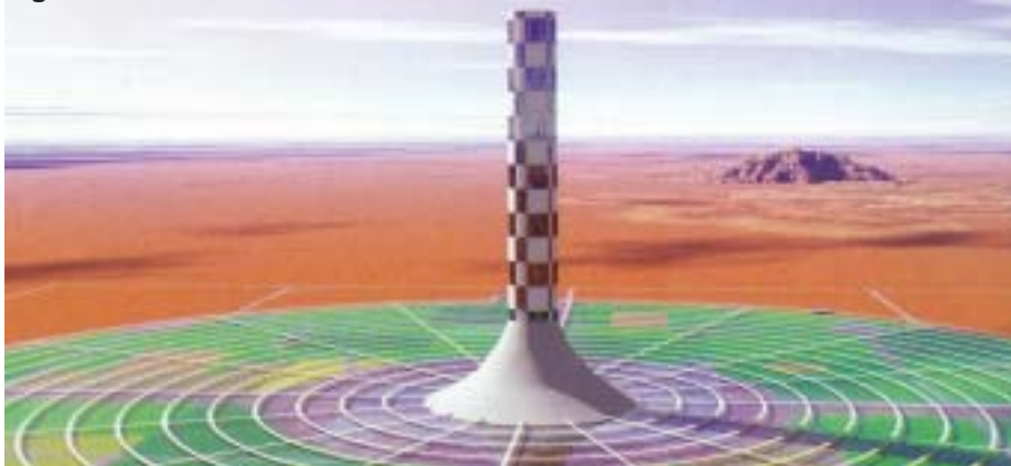
Figura 2. Progetto di centrale elettrica solare di 200 MW nel deserto australiano funzionante sugli stessi principi della ventola del girarrosto di Leonardo.
