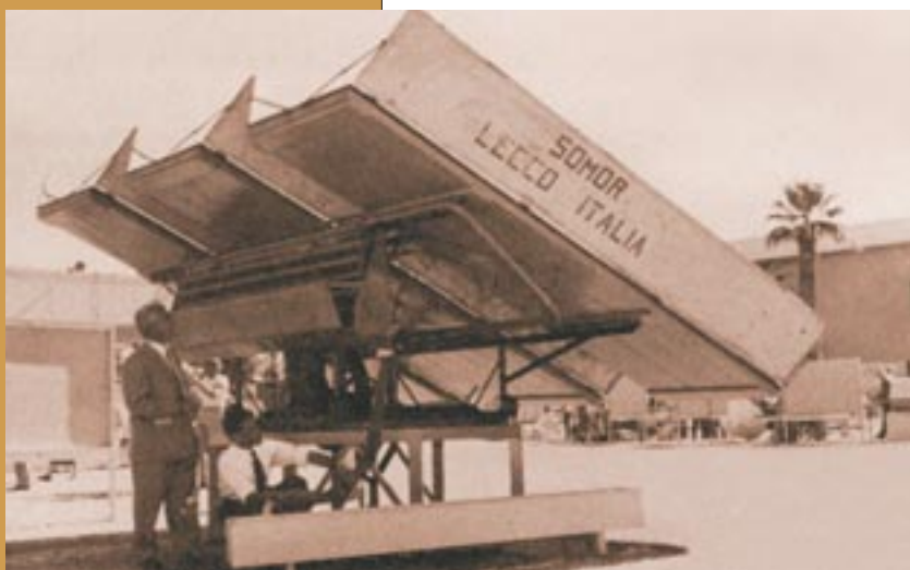
La pompa solare per sollevare l'acqua di fabbricazione italiana esposta in Arizona nel 1955 e costruita dalla ditta Somor di Lecco dell'ingegnere Ferruccio Grassi con la collaborazione di Daniele Gasperini (Foto da archivio ISES da J. Duffie).
