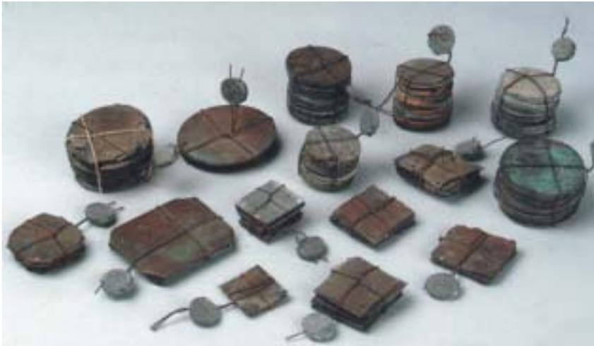
**Figura 2.** Reperti originali di pile, coppie bimetalliche, lastre armate conservate nel Tempio Voltiano di Como.
