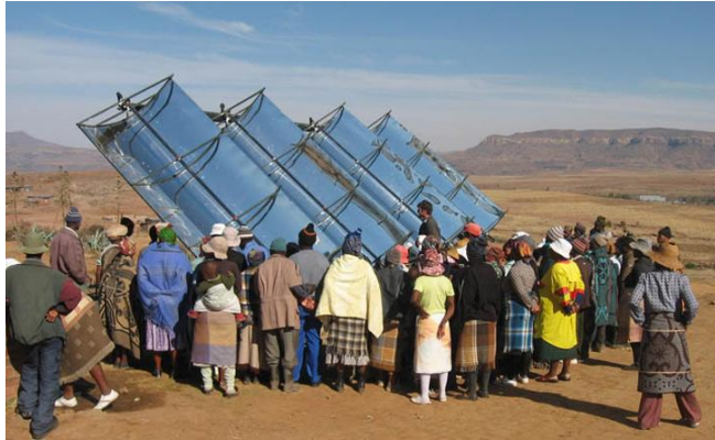
Fig. 2 – Collettori solari parabolici per un motore ORC progettato per fornire calore, elettricità ed acqua calda a comunità isolate. Lo specifico progetto è della STG International ( http://www.stginternational.org/ )
