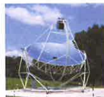
Eurodish - Prototipo di concentratore parabolico puntuale con motore stirling da 10 kW, in fase di messa a punto dal mese di luglio 2002, presso il CESI (Milano).
